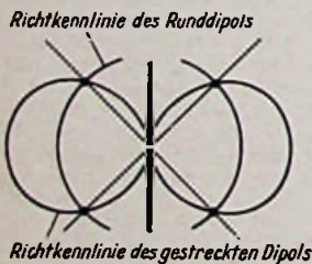
Bild 8. Vergleich zwischen Runddipol und gestrecktem Dipol
